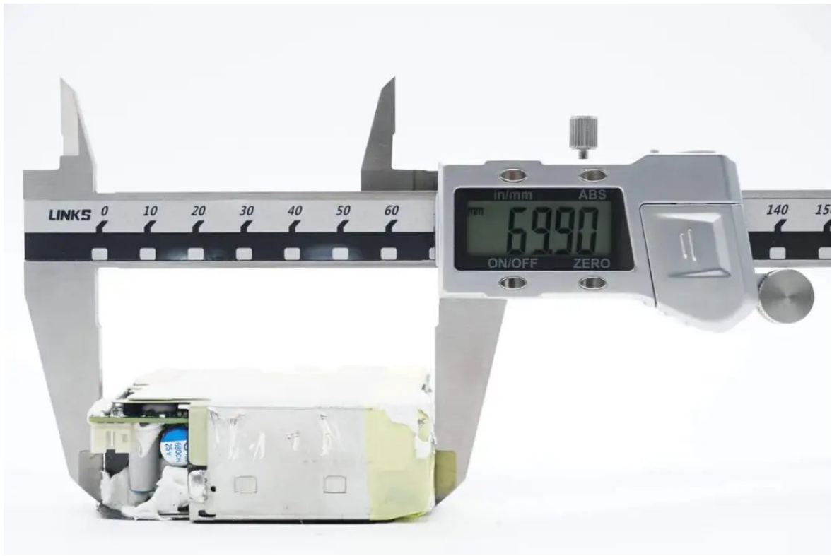
测得PCBA模块长度为69.9mm。
