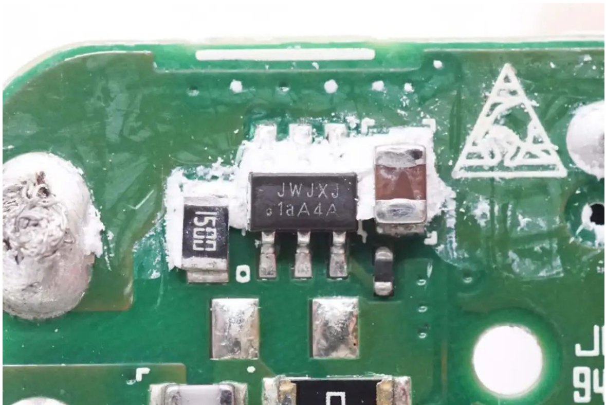
同步整流控制器丝印JWJXJ，来自杰华特。
